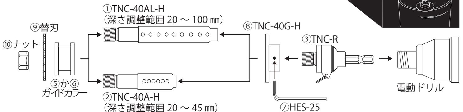
⑧TNC-40G-Hを①TNC-40AL-Hか②TNC-40A-Hの切断深さの目盛に合わせ、⑦HES-25で止めネジを締めて固定します。
