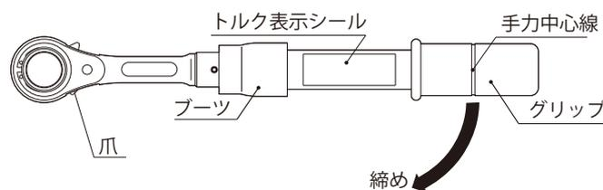
右ネジ締め付け方向のみトルク締めできます。
